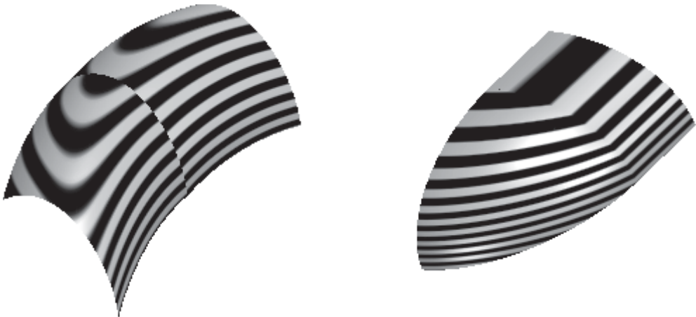
図5 曲面のハイライト線表示（左：折れのある面，右：曲率不連続の面）
