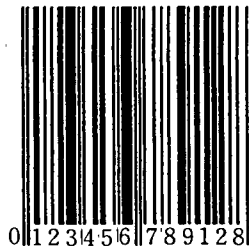
図 5 バーコード下のヒューマン・リーダブルエリアへの印字例 Fig. 5 Human readable interpretation of the bar code data
